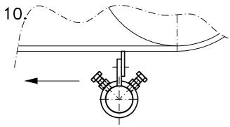
Befestigen des Trägerrohres: Die Feststellschrauben an der Halterung so fest anziehen, das ein Verdrehen des Rohres nicht möglich ist. Anschließend mit den Kontermuttern sichern.
